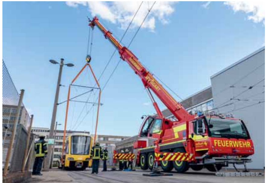
Anheben einer Stadtbahn mit einem Feuerwehrkran
