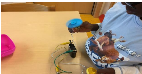
Abbildung 7, Foto: KiFaZ. Falsch gepolte Schaltung
