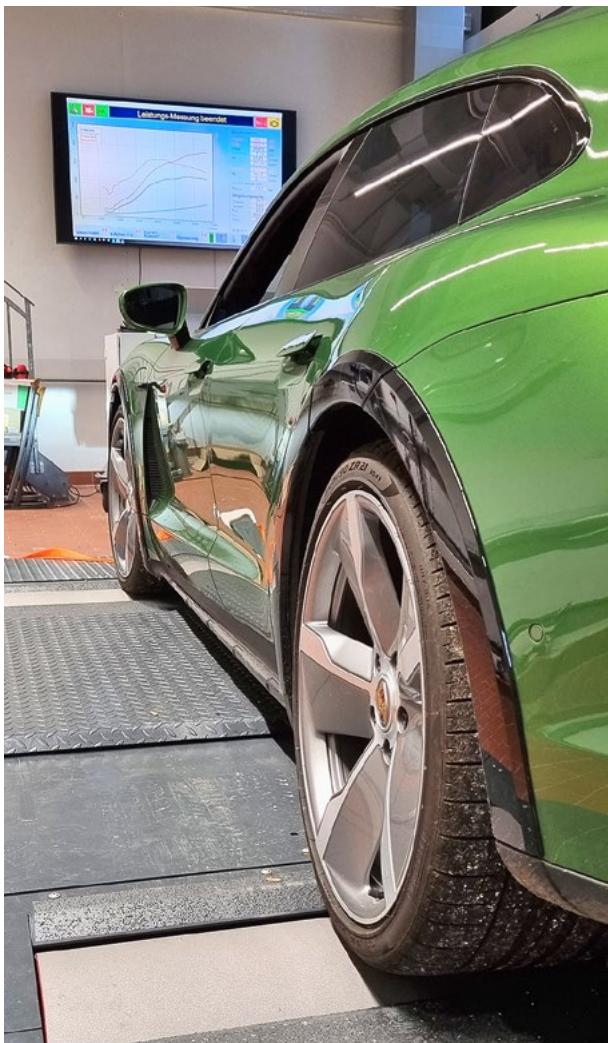
Vollelektrischer Porsche Taycan Sport Turismo mit 300KW/408 PS bei der Leistungsmessung
